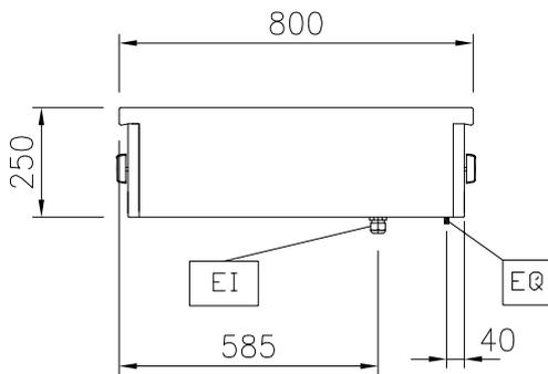
EI = Conexión eléctrica (energía)
